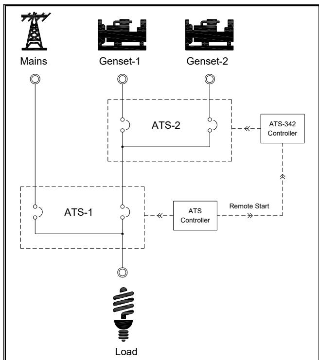
當市電電源品質異常時，ATS-342 控制模組接受遙控起動信號自動執行備用發電機組之起動與切換。當運轉供電中之發電機組發生故障，無法繼續提供穩定且安全之電力品質供負載用電時，ATS-342 控制單元將自動啟動備用發電機組接續負載供電。
