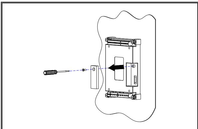
步驟2：將KCU-XX模組插入ATS-342的電路板，並將螺絲鎖緊。
